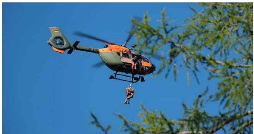
Rettung im Doppelwischverfahren. Die Winde des H145 LUH SAR hat ein Windenseil mit 90 Metern Länge – doppelt so lang wie früher an der „Huey“.
