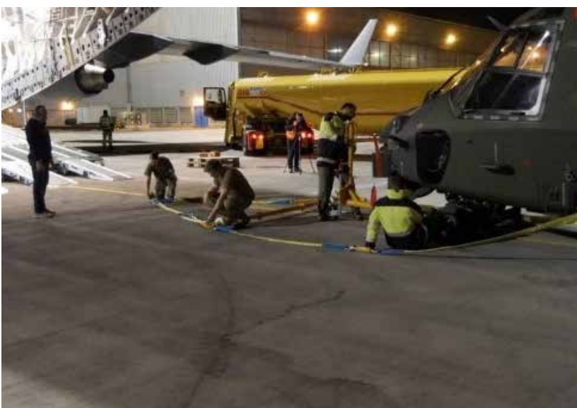
Montage des „Towing Cable“.
